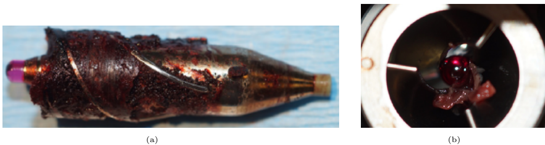
Figura 1: Exemplo de trombos formados no interior de um DAV. O trombo vermelho é ilustrado em (a) e o branco em (b) - Extraído de [9].
